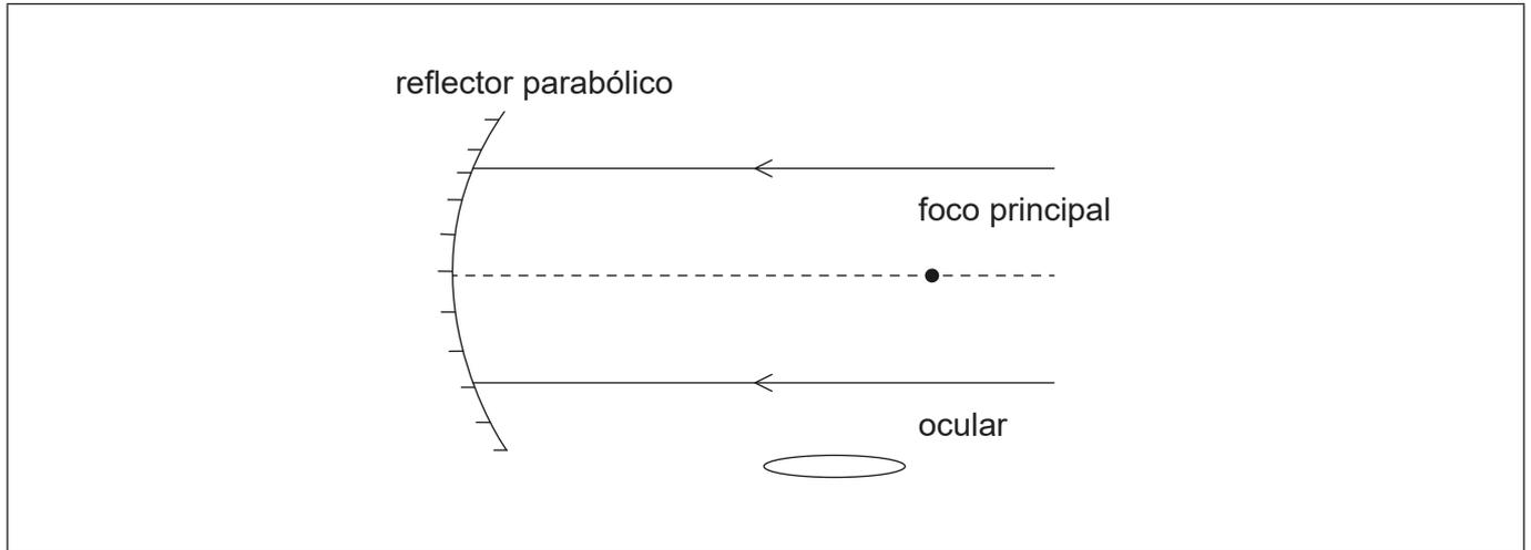
(a) Complete el diagrama, con diseño newtoniano, prolongando los **dos** rayos para mostrar cómo pasan por el ocular. [3]
